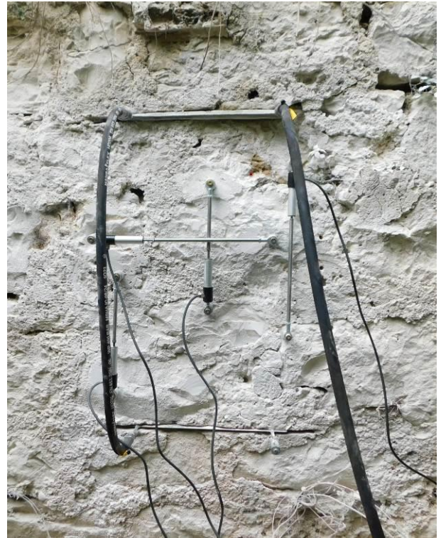
Slika 2-19 Umetanje tlačnih jastuka i postava uređaja za mjerjenje pomaka
