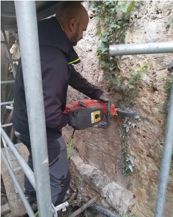
Slika 2-18 Prikaz izrade rezova u zidu za umetanje tlačnih jastuka – pozicija FJ1
