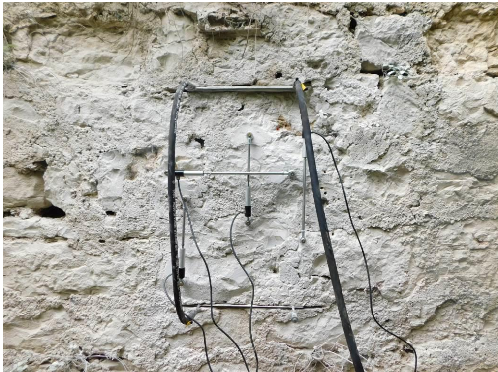
Slika 2-22 Prikaz ispitnog sklopa na poziciji FJ3 – unošenje pritiska u tlačnim jastucima
