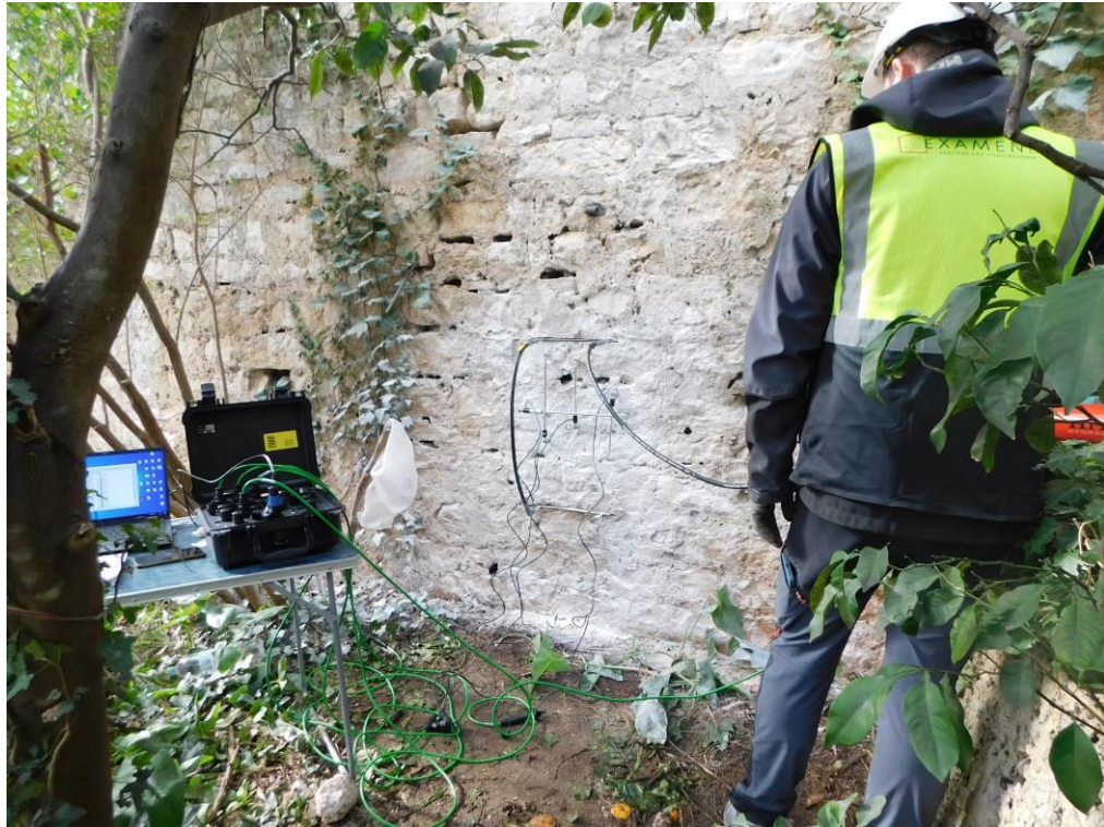
Slika 2-21 Prikaz ispitnog sklopa na poziciji FJ2 – unošenje pritiska u tlačnim jastucima
