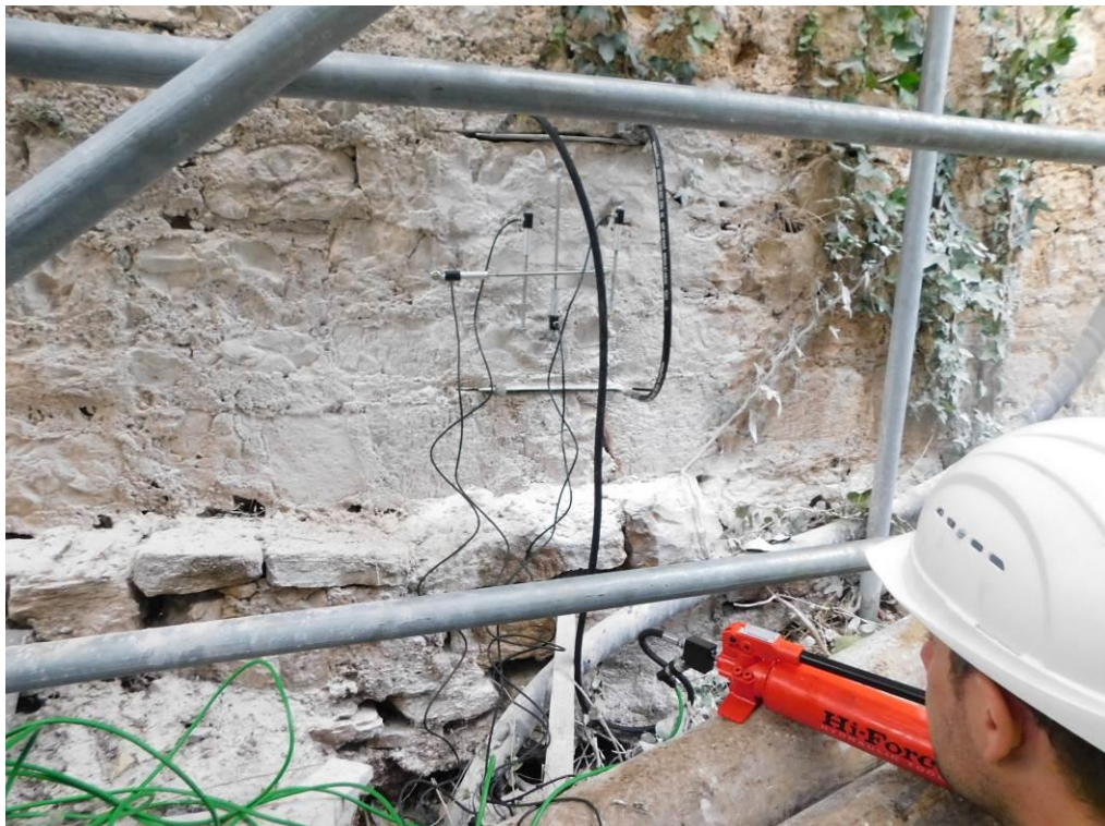
Slika 2-20 Prikaz ispitnog sklopa na poziciji FJ1 – unošenje pritiska u tlačnim jastucima
